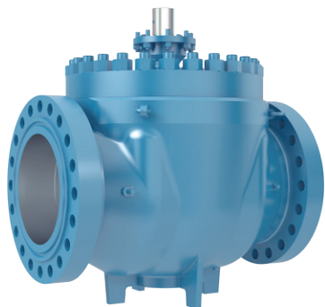
КРАНЫ ШАРОВЫЕ С ВЕРХНИМ РАЗЪЕМОМ DN 50...1400 мм PN 1,6...42,0 МПа
